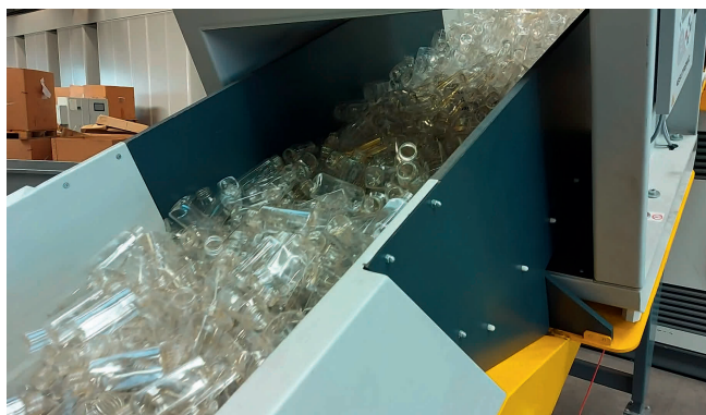
Beschickung des Shredder-Förderbandes mit PLA Flaschen: NGR unterstützt als Technologiepartner das Vorhaben des österreichischen Unternehmens. © NaKu
