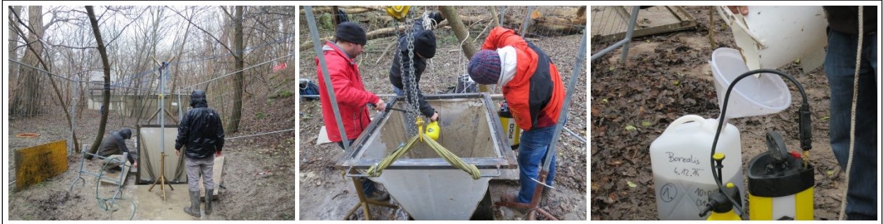
Abbildung 15: Messaufbau Fa. Borealis – links: Bergung des Messgerätes; Mitte: Reinigung des Messnetzes; rechts: Einfüllen des Fanggutes in den Probenbehälter. © IWHW/BOKU
