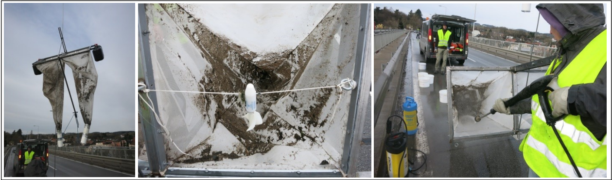
Abbildung 6: Reinigung des Messgerätes direkt nach der Messung. © IHHW/BOKU
