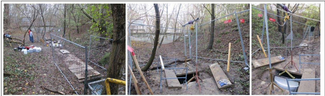
Abbildung 13: Messaufbau Fa. Borealis – links: Messstelle im Hintergrund; Mitte: Aufbau zur Probennahme; rechts: Metallrahmen inkl. Netz im Ablaufgerinne. © IWHW/BOKU
