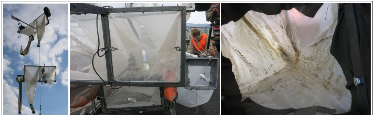
Abbildung 3: Zusammenstellung der Messtechnik für die Messung mit dem 41\ \mu\text{m} -Netz. © IWHW/BOKU
